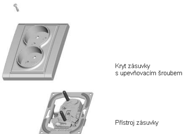
Obr. 6: Sestavování dvojnásobné zásuvky s krytem a integrovaným rámečkem
